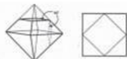
Fig.6-40. Observando la cara (der) creada al truncar las seis puntas de un octaedro (izq, mostrado con solo una punta truncada y otra a 90 grados)
